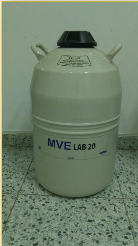
**TANQUE NITRÓGENO DE 20LTS PARA
