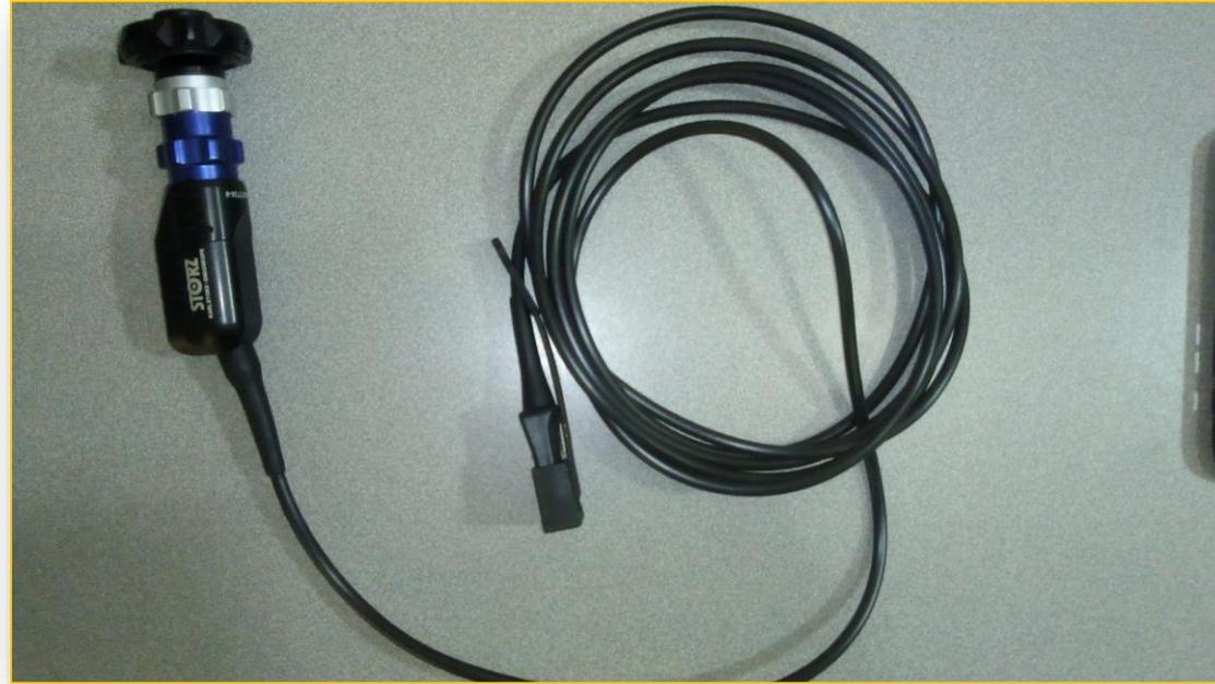
**CABEZAL DE CÁMARA DE 1. CHIP. TELECAM.**
